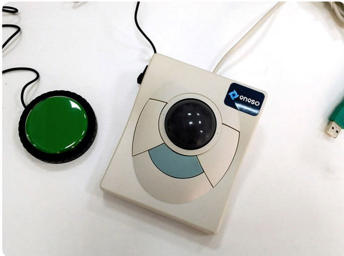
Este ratón de bola adaptado con conexión USB te permite utilizar el ordenador con más facilidad aún, ya que ha sido modificado para que puedas utilizarlo con pulsadores. Dispone de dos entradas para conmutador estándar, pudiendo conectar uno o dos pulsadores para sustituir el botón izquierdo y derecho del ratón.
